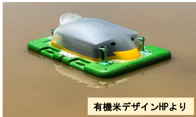
浮遊型の水田除草ロボット (アイガモロボット)の開発
