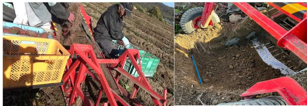
写真2 改良機による収穫作業の様子
